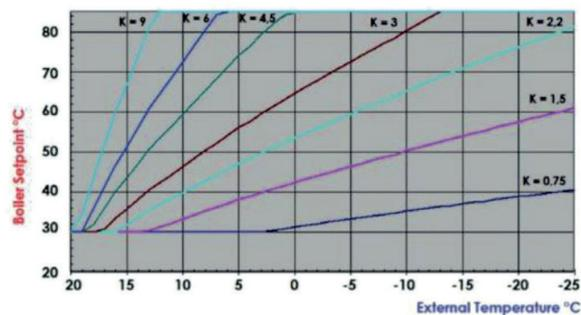
Figura 44: Curvas de operación de la sonda externa
