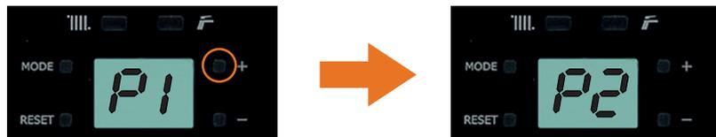
16. Modificar los valores de CO2 mediante la tecla + o - del grifo de ACS, hasta alcanzar los valores de la tabla 3.4.2
