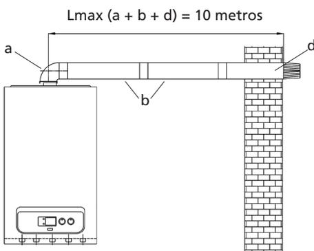
Figura 32: Instalación de chimenea simple con codo de 90°
