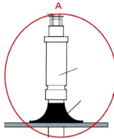
Figura 36: Aislante para la transición de tejado
