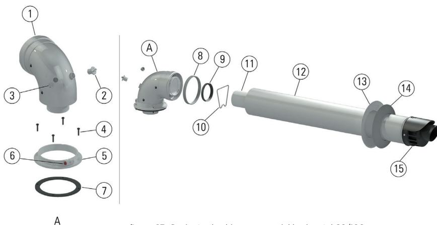
figura 27: Conjunto de chimenea coaxial horizontal 60/100
