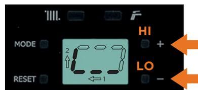
5. Para salir de la función deshollinador pulse la tecla “RESET” + “MODE” hasta completar el círculo de confirmación.
