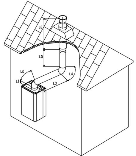
Figura 37: Aplicación de chimenea vertical
