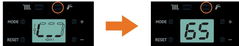
8. Modificar los valores de CO2 mediante la tecla + o - del grifo de ACS, hasta alcanzar los valores de la tabla 3.4.2.
