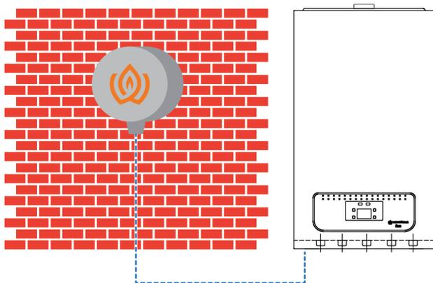
Figura 43: Sonda externa
