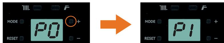
11. Cuando la combustión sea estable, (**obligatorio esperar 1 minuto, sino no dejará entrar en la programación**), pulsar el botón de ACS hasta completar el círculo de confirmación y aparecerá en pantalla “el valor de llama en el encendido”, este valor puede cambiar según las condiciones de cada caldera.
